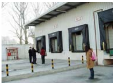
以大车码头为主的大小车码头搭配设计 (小车停靠区域垫起35厘米)
